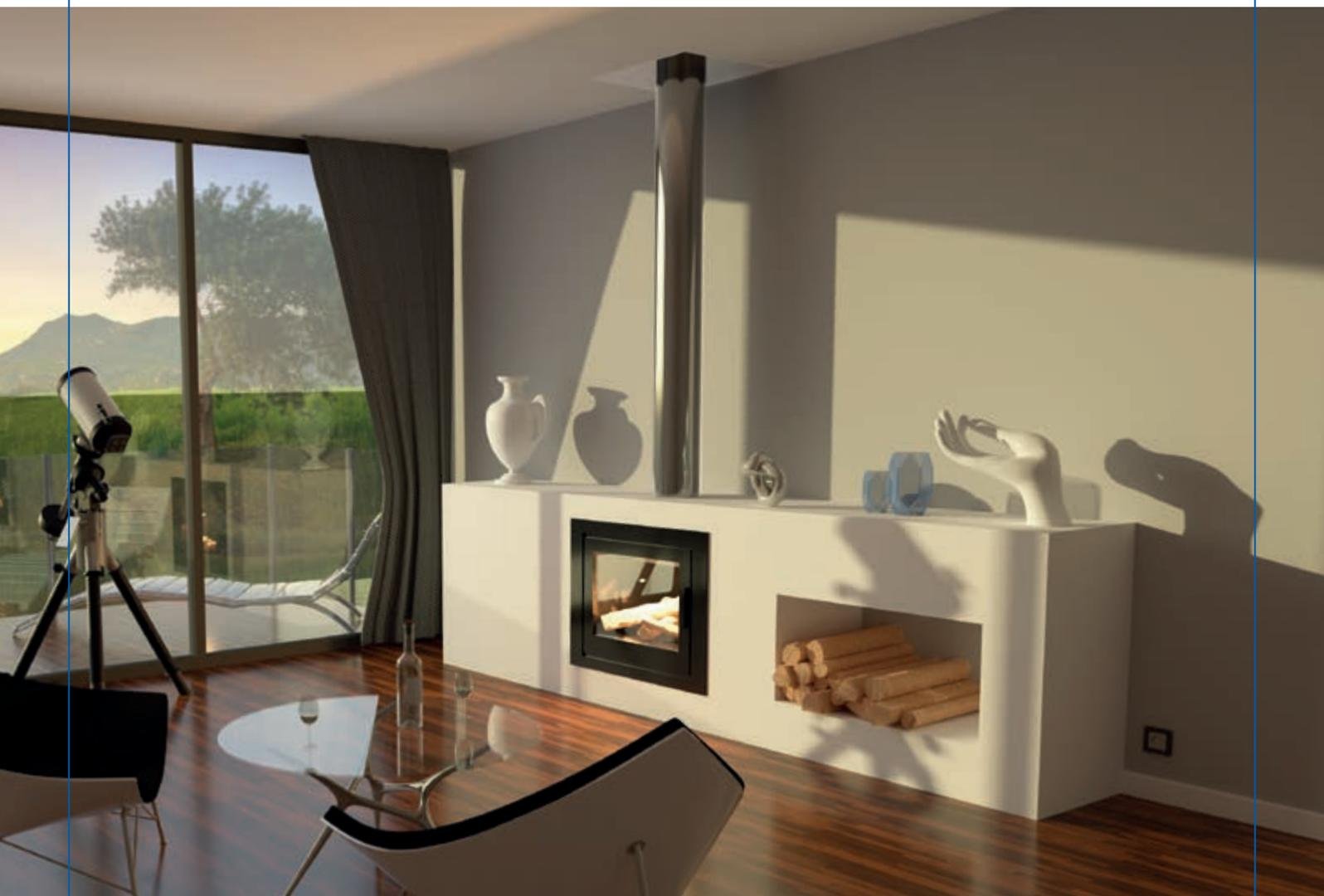
Unser Edelstahl-Abgassystem Geschoss-DW wurde speziell für die Anforderungen des Schweizer Marktes entwickelt. Es darf ohne Ummantelung oder Schacht eingebaut werden und erfüllt die Brandschutzanforderungen der Feuerwiderstandsklasse EI30/EI60.
