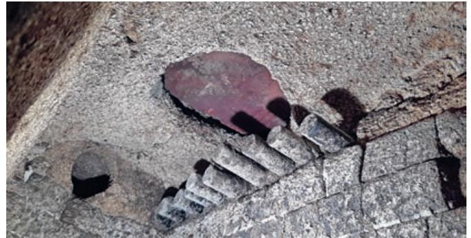
Plafond du foyer avec les tuyaux de vapeur supérieurs / Vanne gueulard fermée / Ouverture de tirage direct à l'arrière.
